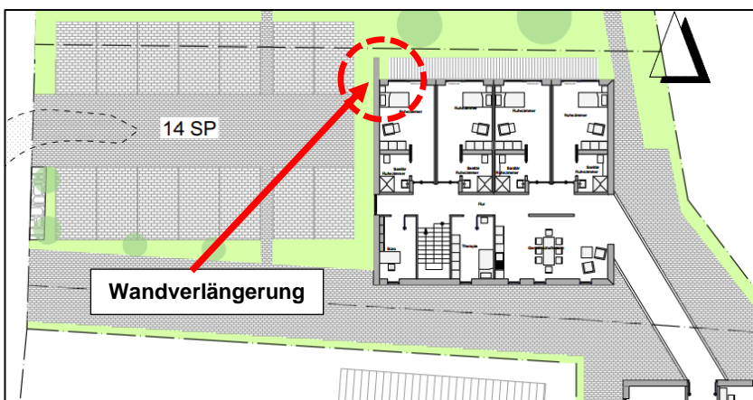
Abbildung 19: Immissionsschutzmaßnahmen (Quelle: INGENIEURBÜRO FRANK UND SCHELLENBERGER GbR; GUTACHTEN NR. LG 60/2023 - Anlage 6)
