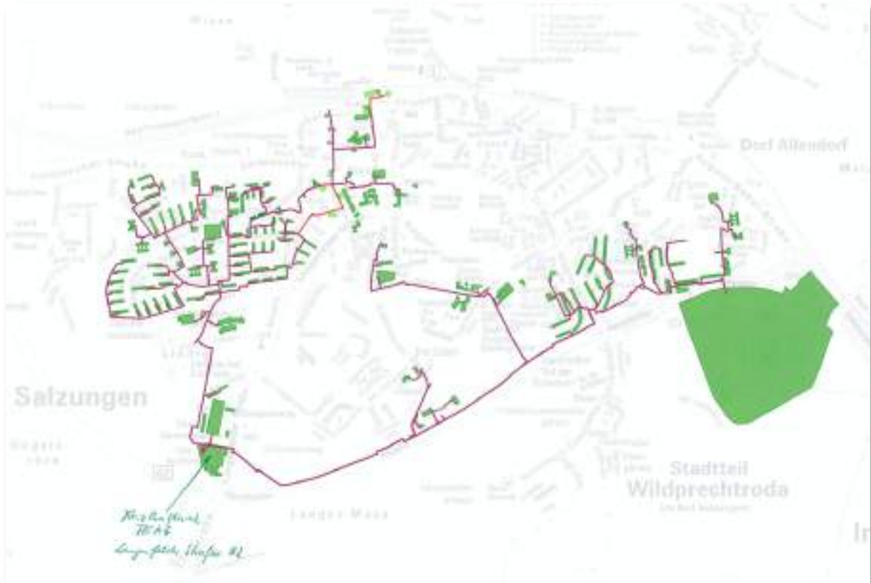
Abbildung 82: Fernwärmenetz Kernstadt, TEAG Trassenplan vom 28.06.2023
